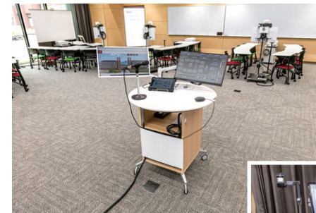
▲全ての映像・音響機器をタッチパネルでコントロールできる教室中央のモデレータステーション
