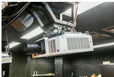
▲1面表示の際は340型相当で投写。2台採用された液晶レーザープロジェクターPT-MZ17KJL
