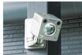
▲車が入ってきたときに厨房へ知らせる屋外対応カメラ
